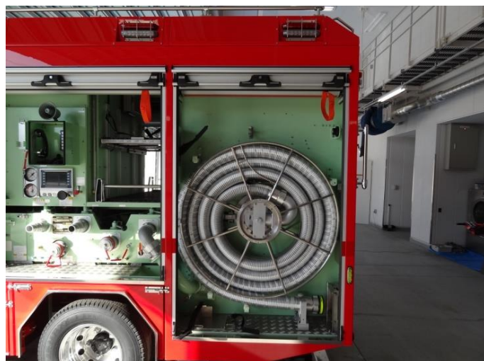
車両後部には巻取り式の軽量吸管を装備
